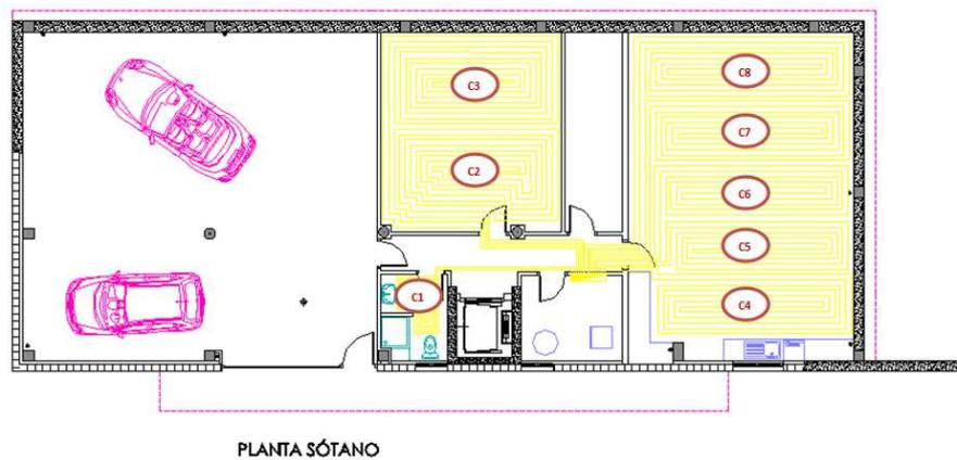
**Figura 3. Nomenclatura circuitos planta sótano**
